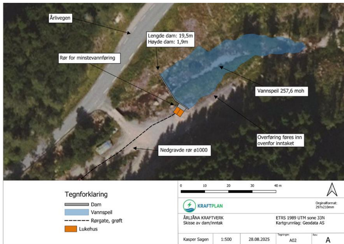
Figur 2.5. Planlagt dam ved inntaket (Småkraft 2025).
